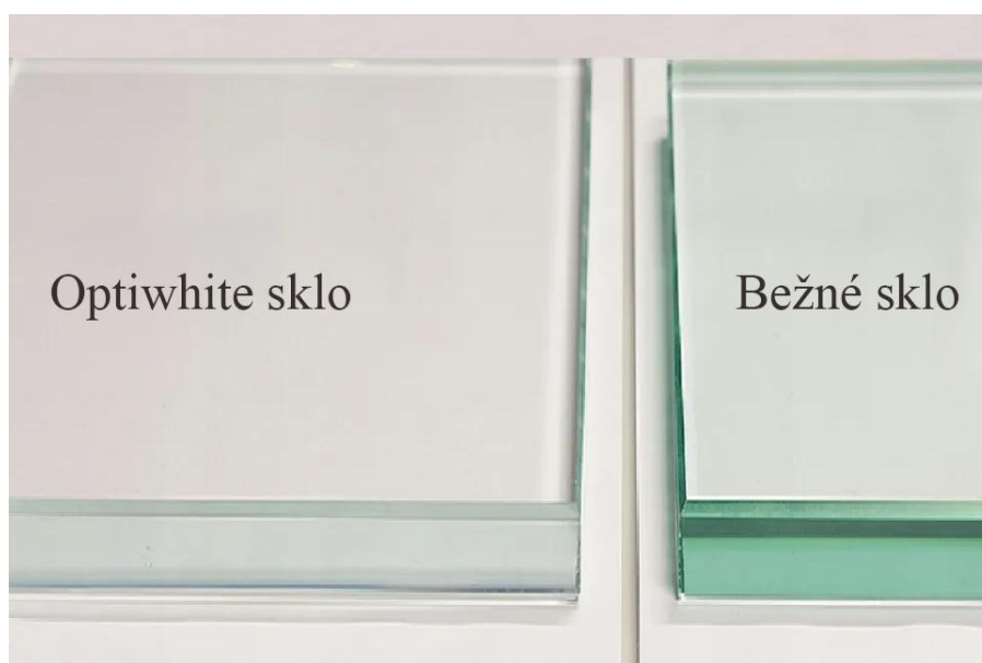
Obrázok 42 Optiwhite a bežné sklo. Zdroj: https://klaas24.ee/en/product/optiwhite-klaas-eriti-kirgas-klaas/
