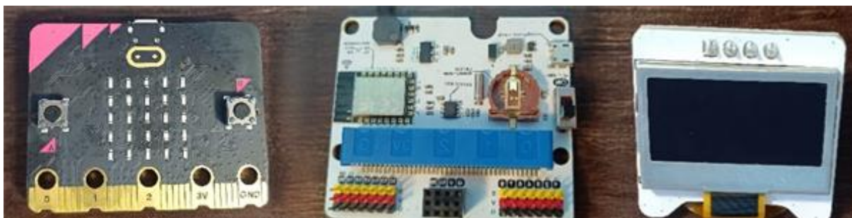
Obrázok 33 Doska BBC micro:bit - rozširujúca doska pre BBC micro:bit - displej na zobrazenie údajov
