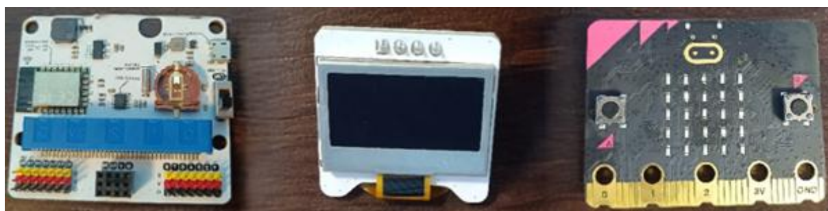
Obrázok 15 Rozširujúca doska - Rozširujúci displej - Doska BBC micro:bit
