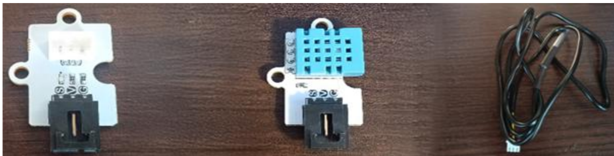
Obrázok 16 Doska na pripojenie senzora - Senzor DHT11 - Senzor DS18B20
