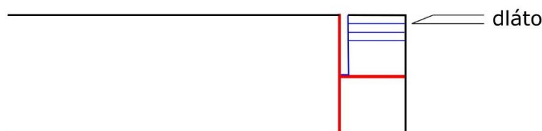
Správny spôsob vedenia rezu pílkou a postup dlabania dlátom
