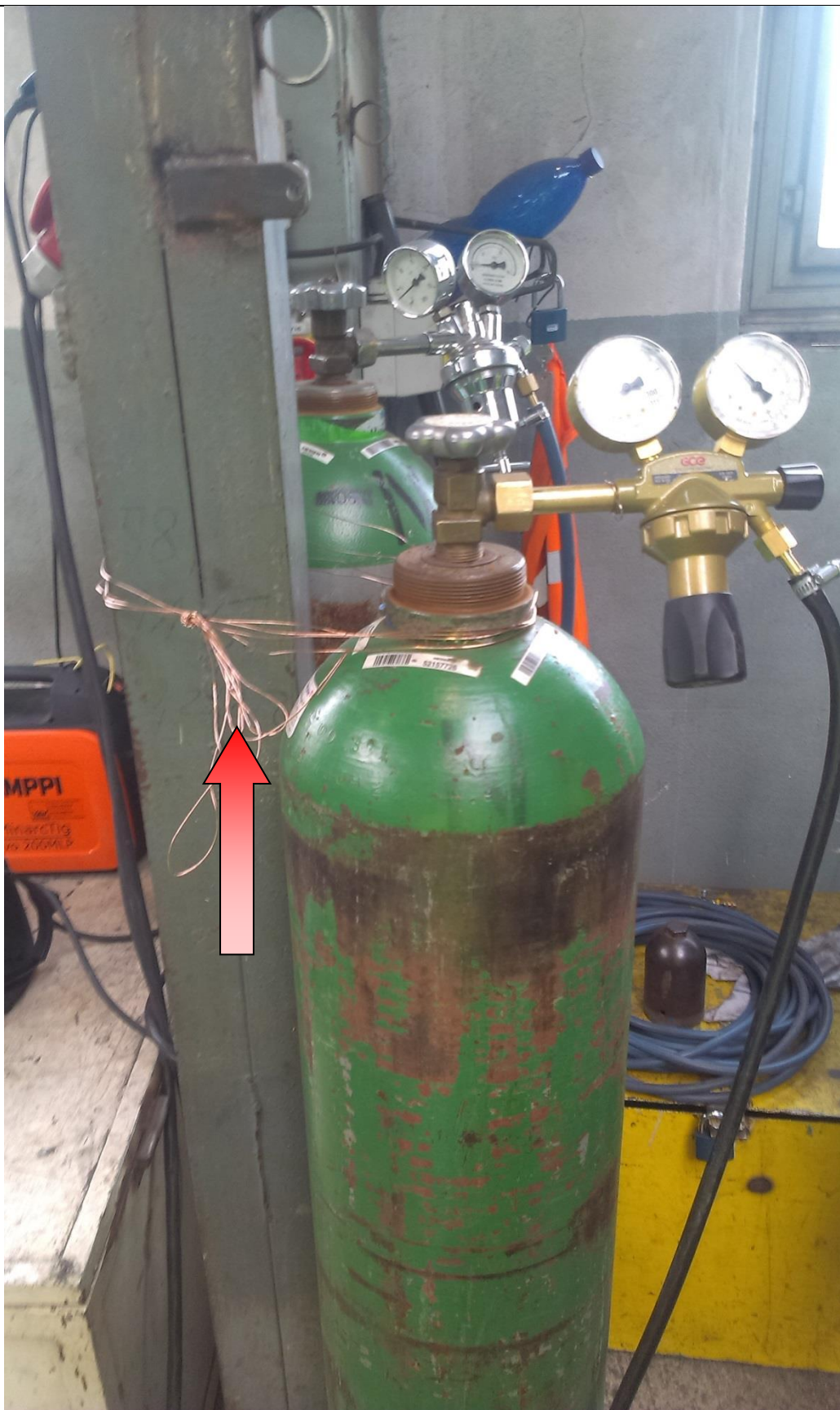
Obrázok 13 Nesprávne uchytenie tlakovej
