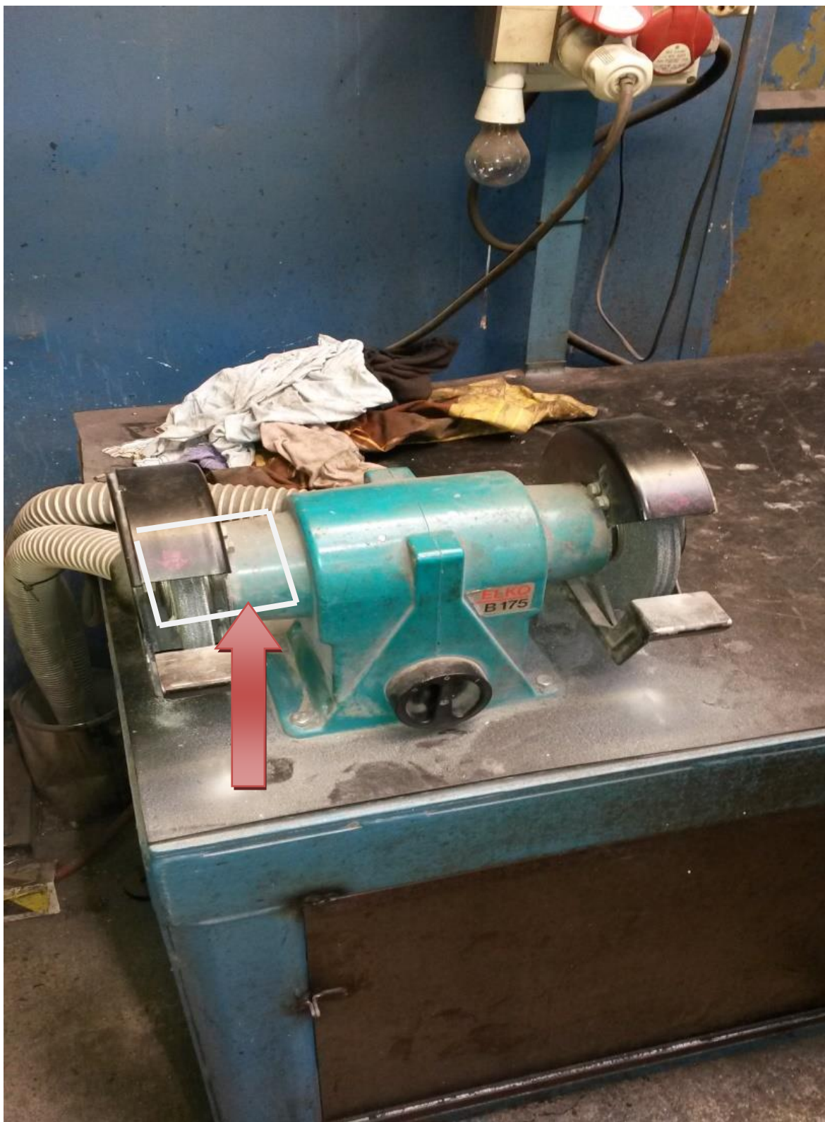
Obrázok 1 Zámočnícka dielňa. Dvojkotúčová stolová brúska, ktorej chýbajú sklíčka pred odletujúcimi trieskami pri brúsení
