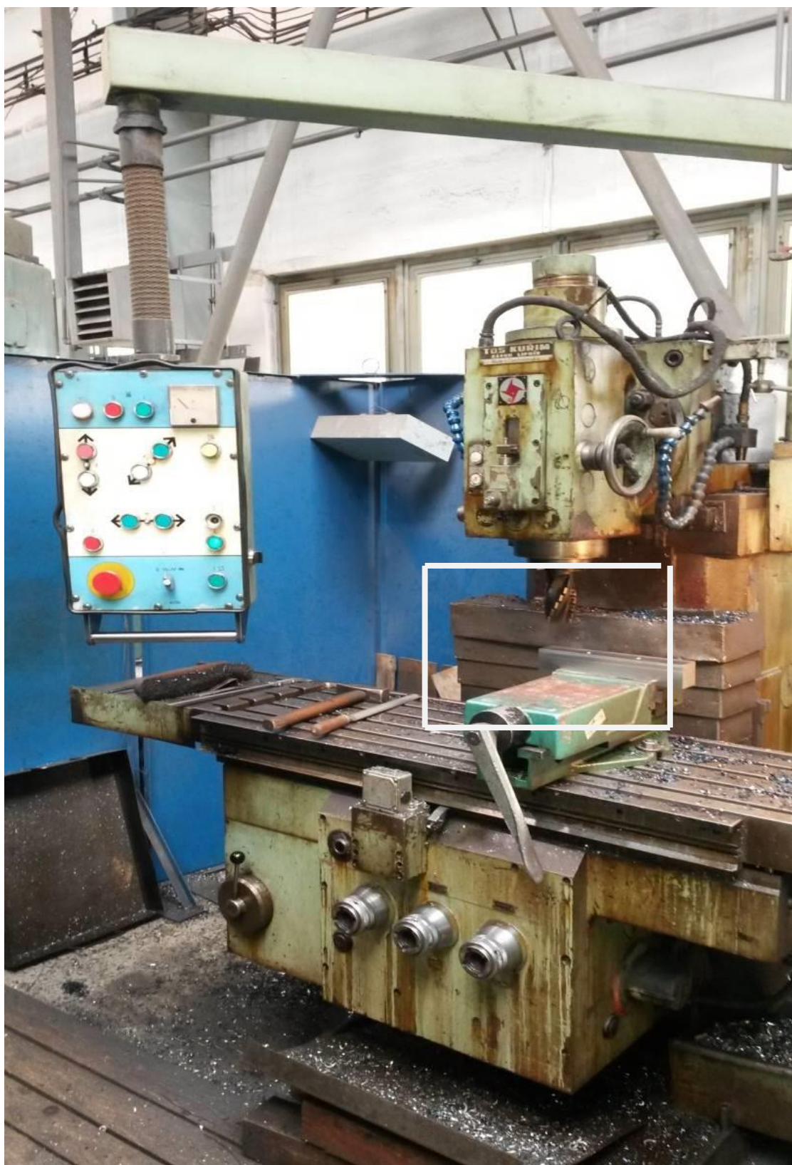
Obrázok 2 Zámočnícka dielňa. Fréza ktorej chýba kryt ktorý chráni pracovníka pred odletujúcimi trieskami
