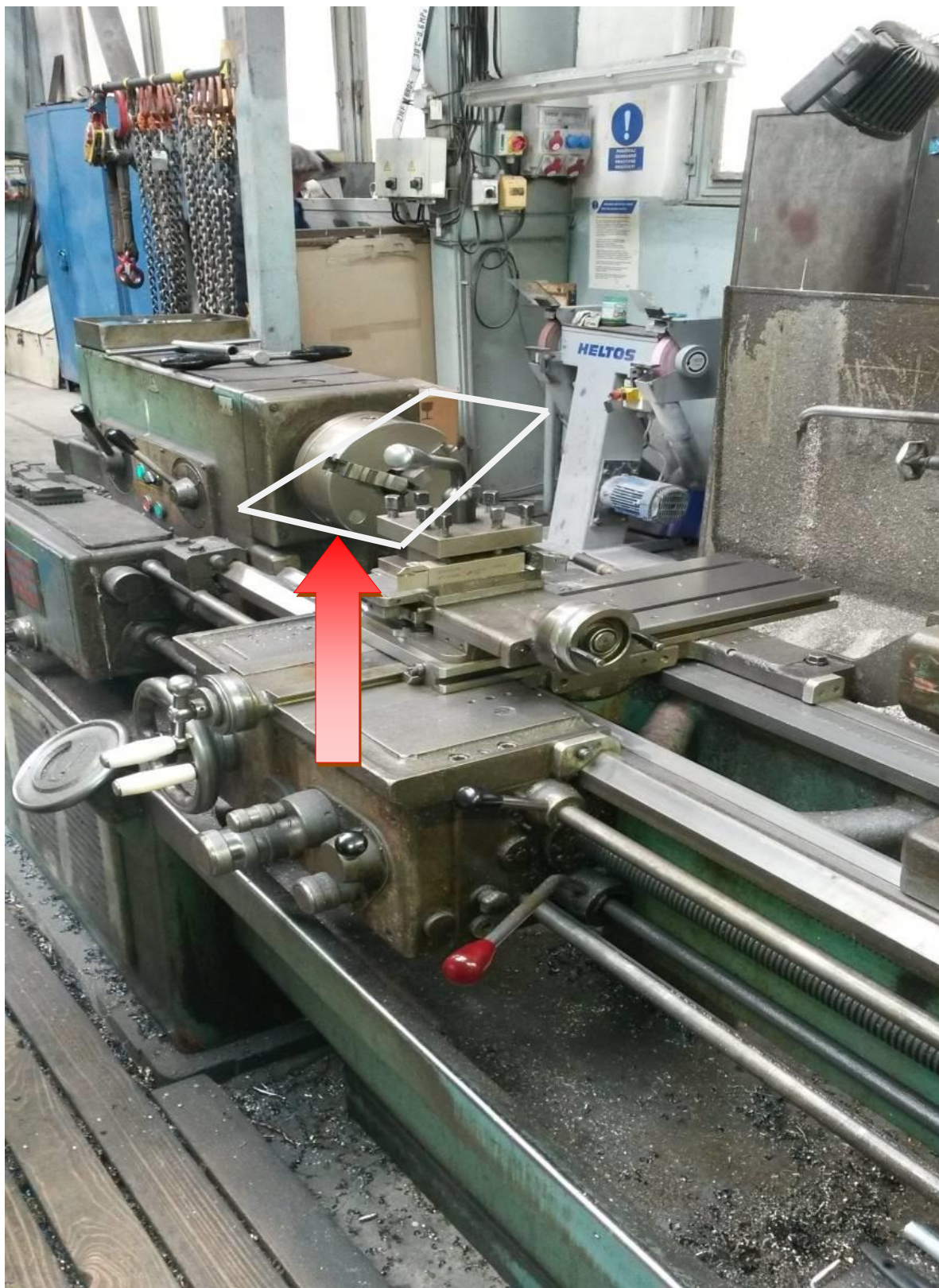
Obrázok 3 Zámočnícka dielňa. Univerzálny hrotový sústruh, ktorému chýba kryt točiaceho skl'učovadla
