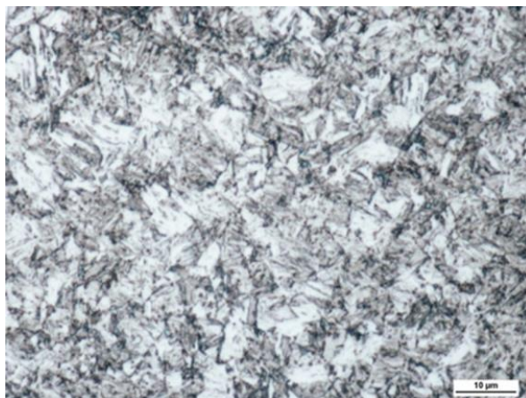
Obrázok 20 Martenzitická mikroštruktúra - pri rýchlosti ochladzovania 300 °C/s, tvrdosť 412 HV 30 (zdroj, http://ebook.veda-hrou.cz/cms/14-kapitola-4-tepelne-zpracovani-oceli.html )
