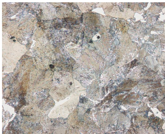
Obrázok 23 Pod mikroskopom sú viditeľné štruktúry perlitu medzi kryštálmi feritu. Oceľ s obsahom 0,765 % C. (zdroj, http://sk.wikipedia.org/wiki/Perlit_%28metalurgia%29 )
