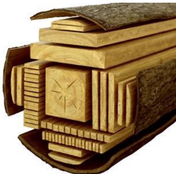
Obrázok 93 Ukážka porezu kmeňa dreva (zdroj, http://www.rezbarstvo.sk/index.php?option=com_content&view=article&id=126:stavba-dreva&catid=28:materialy&Itemid=51 )
