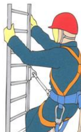
Obrázok 12: ochrana pri výstupoch s použitím pevného vedenia
