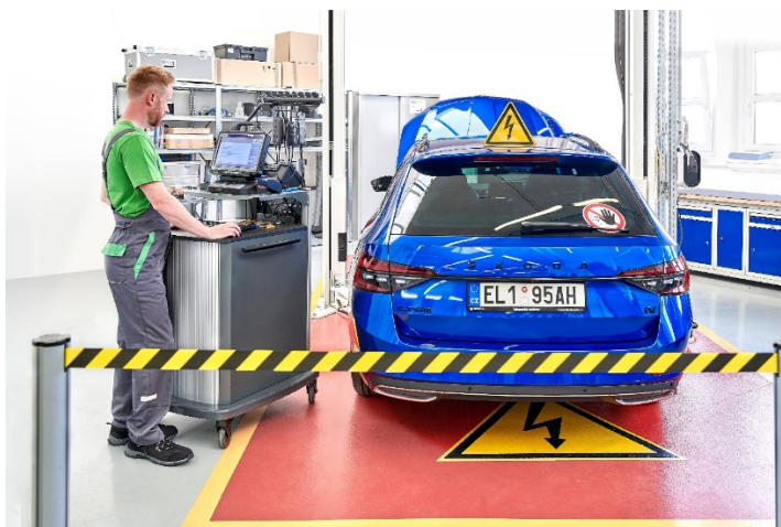
Obrázok 10 Vyhradené pracovisko na prácu s elektromobilom
