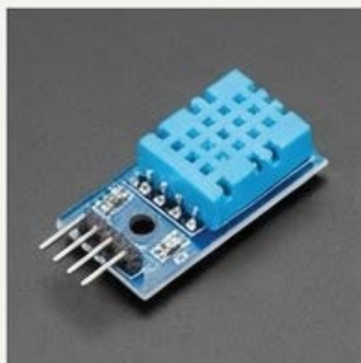
Senzor DHT11: Meria teplotu a vlhkosť okolitého vzduchu.
