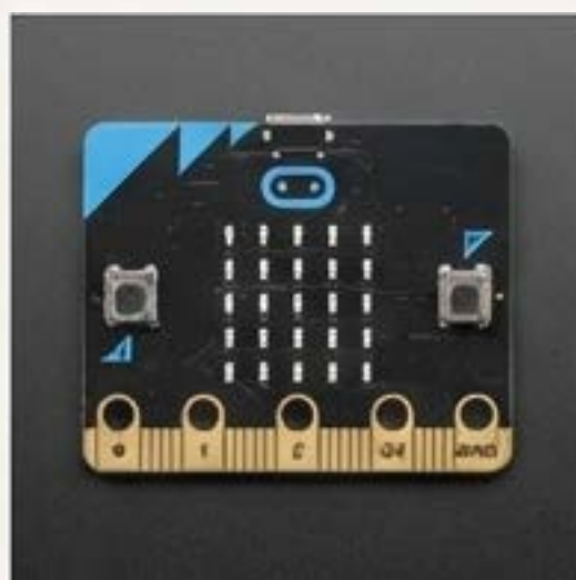
BBC micro:bit: Riadiaca jednotka – mozog celého projektu.
