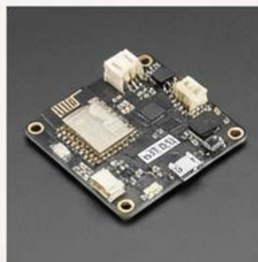
IoT:bit doska: Rozširujúci modul – umožňuje jednoduché pripojenie a pridáva WiFi.
