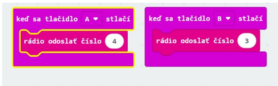
Obrázok 19 Naprogramovanie manuálneho ovládania čerpadla
