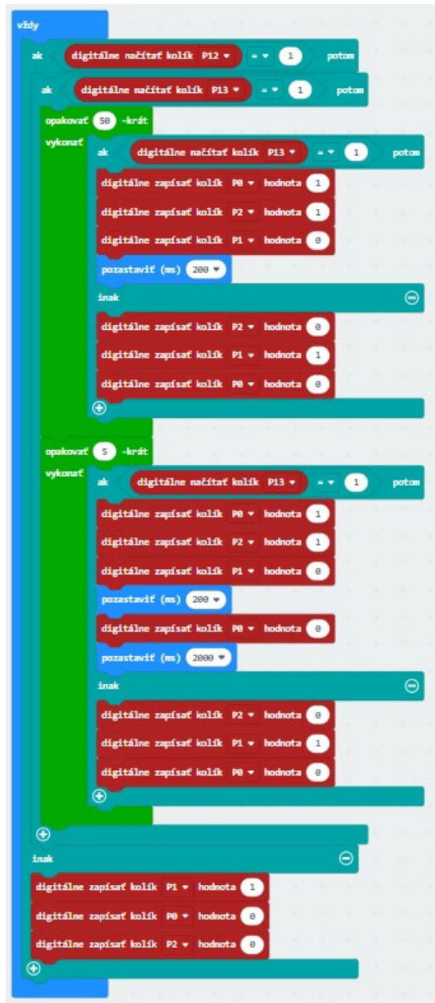
Obrázok 7 Riadiaci program pre model automatickej práčky
