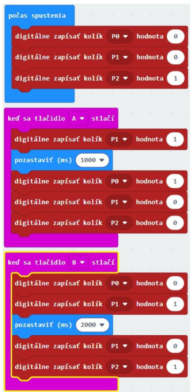
Obrázok 6 Riadiaci program pre model semaforu riadeného tlačidlami
