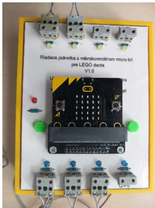
Obrázok 4 Riadiaca jednotka s mikrokontrolérom BBC micro:bit
