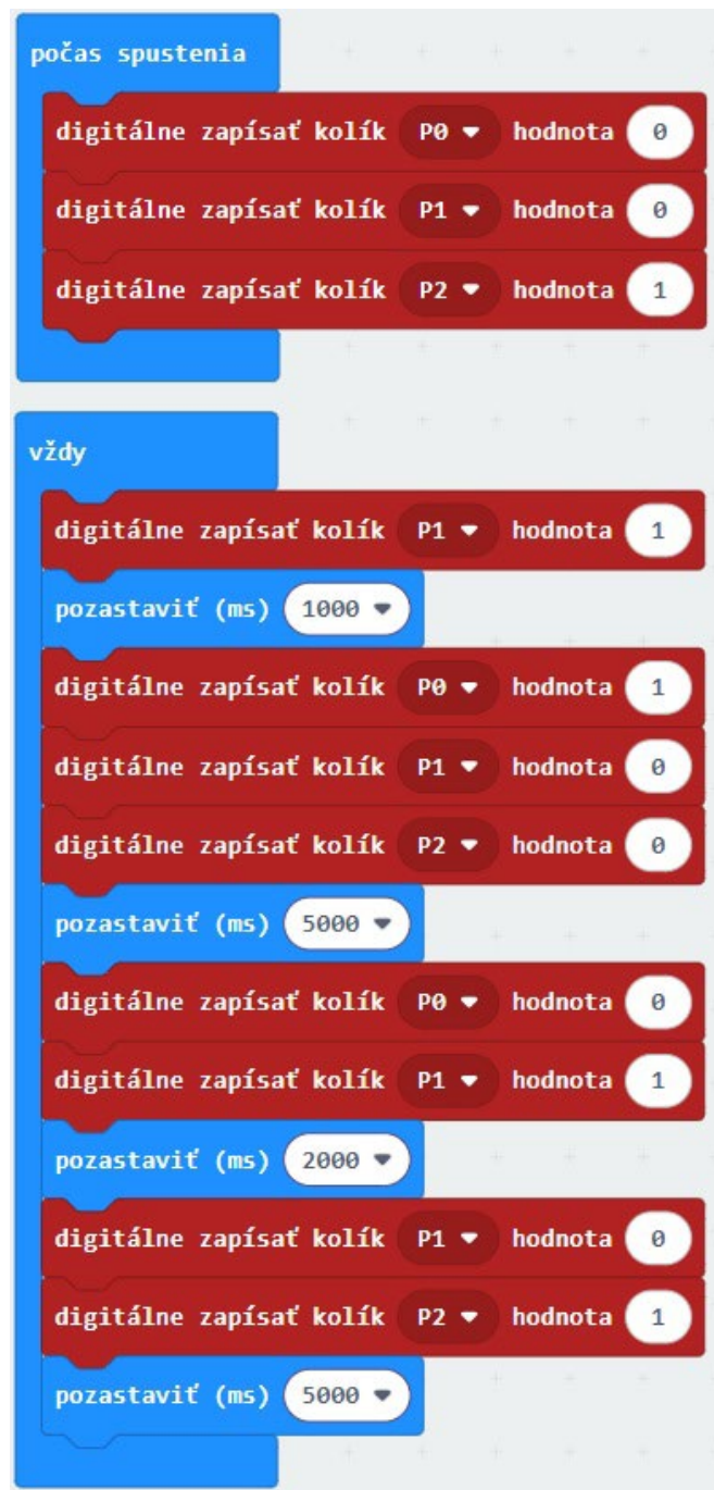
Obrázok 7 Riadiaci program pre model semaforu riadeného automaticky
