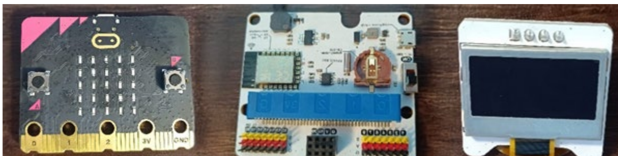
Obrázok 8 Doska BBC micro:bit - rozširujúca doska pre BBC micro:bit - displej na zobrazenie údajov
